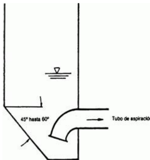
Fig. 38 Bisel del fondo del pozo de bombas contra depósito y acumulación de sólidos.
